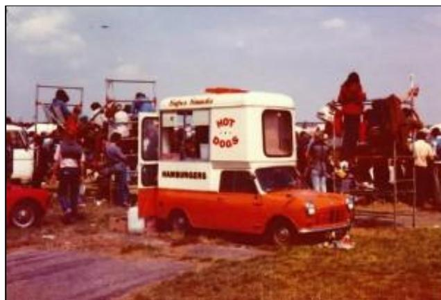
**Hot Dog Vans** - Der größte Unterschied zwischen dem Eiscreme Van und dem Hot Dog Van bestand darin, daß der hintere Heckscheibenabschnitt vorhanden blieb und der Betreiber die abgetrennte Hälfte durch eine zusätzliche Tür betreten konnte. Es wird vermutet, daß dies an Sicherheits- und eventuell auch Geruchsgründen geschah. (Bild oben)
