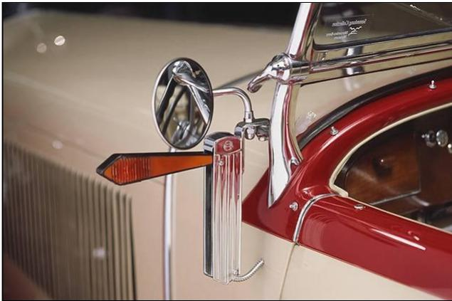
Nach mehreren schweren Verkehrsunfällen wurde bereits im Jahr 1912 über eine technische Neuerung im Personenverkehr nachgedacht, doch erst 1922 erschien der erste funktionsfähige Fahrtrichtungsanzeiger (Armwinker), von Eugen Zipperle und Dr. August Nagel der mittels Bowdenzügen bewegt wurde.
