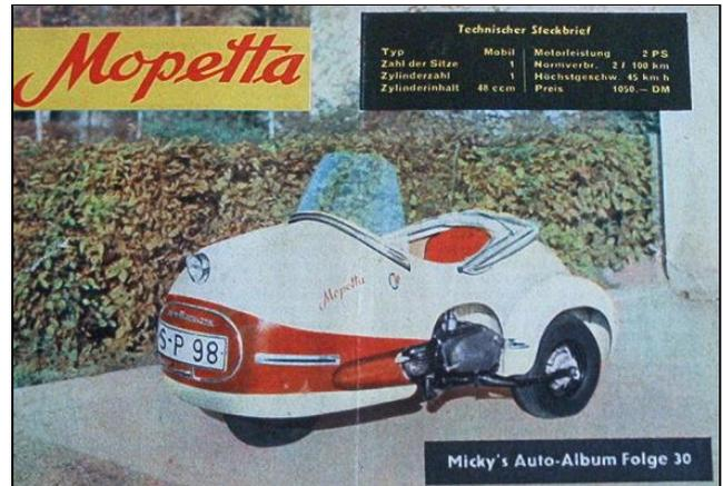
So entstand schließlich die **Brütsch Mopetta** (1956 - 1958), ein einsitziges Dreirad mit einem 50 cm<sup>3</sup> ILVO V-50-Motor, dass wie sein damaliges Erstlingswerk, der Maserati-Rennwagen im Maßstab 2:1, 750 Mark kostete. Doch auch hier blieb der erhoffte Durchbruch aus und so verließen nur insgesamt vierzehn Fahrzeuge die Produktionsstätte.
